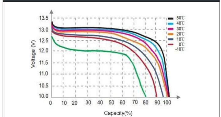
**ZUSAMMENHANG LADEZUSTAND UND SPANNUNG (0.5C 25 °C)**
