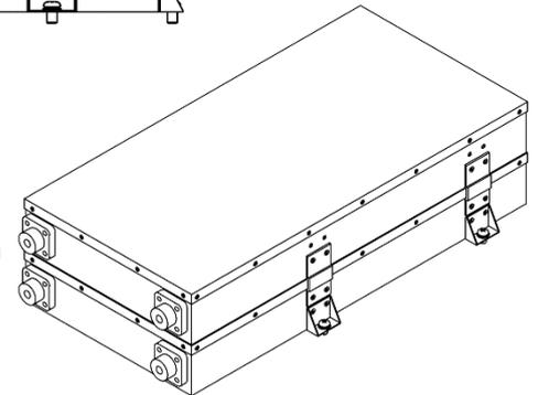
Diese Batterie hat eine Höhe von nur 5,8cm und kann damit in Zwischenböden sowie durch das integrierte Befestigungssystem auch an der Wand fixiert werden.
